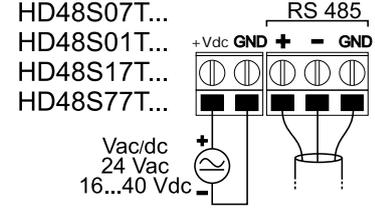
Gracias a la salida RS485, más instrumentos pueden ser conectados a formar una red compuesta por un mínimo de 1 hasta un máximo de 247 instrumentos, conectados en sucesión a través de un cable blindado con par encarrujado para señales y un tercer hilo para la masa.
