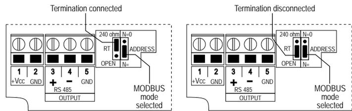
La pantalla del cable debe ser conectada a ambas las extremidades de la línea. El cable debería tener las características siguientes:
